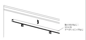
(4) 受け金具の位置を合わせ、ドライバーで固定します。 ※戸先側は枠側から120mm、戸尻側は縦枠から50mmの位置に固定します。
