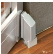
写真:右扉用 材質:スチール/亜鉛合金ダイカスト/ プラスチック 耐荷重:40kg 扉厚:33mm 上下左右前後調整付
